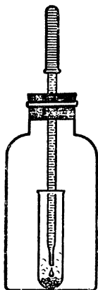
Рис. 347. Вспышка глицерина в закрытой банке при окислении его перман- ганатом ка- лия.
