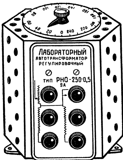
Рис. 95. Лабораторный автотрансформатор РНО-250-9А.
